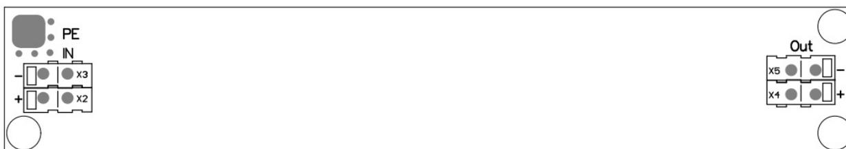
Расположение клемм на плате светильников ЗЕНИТ МК-20-220
