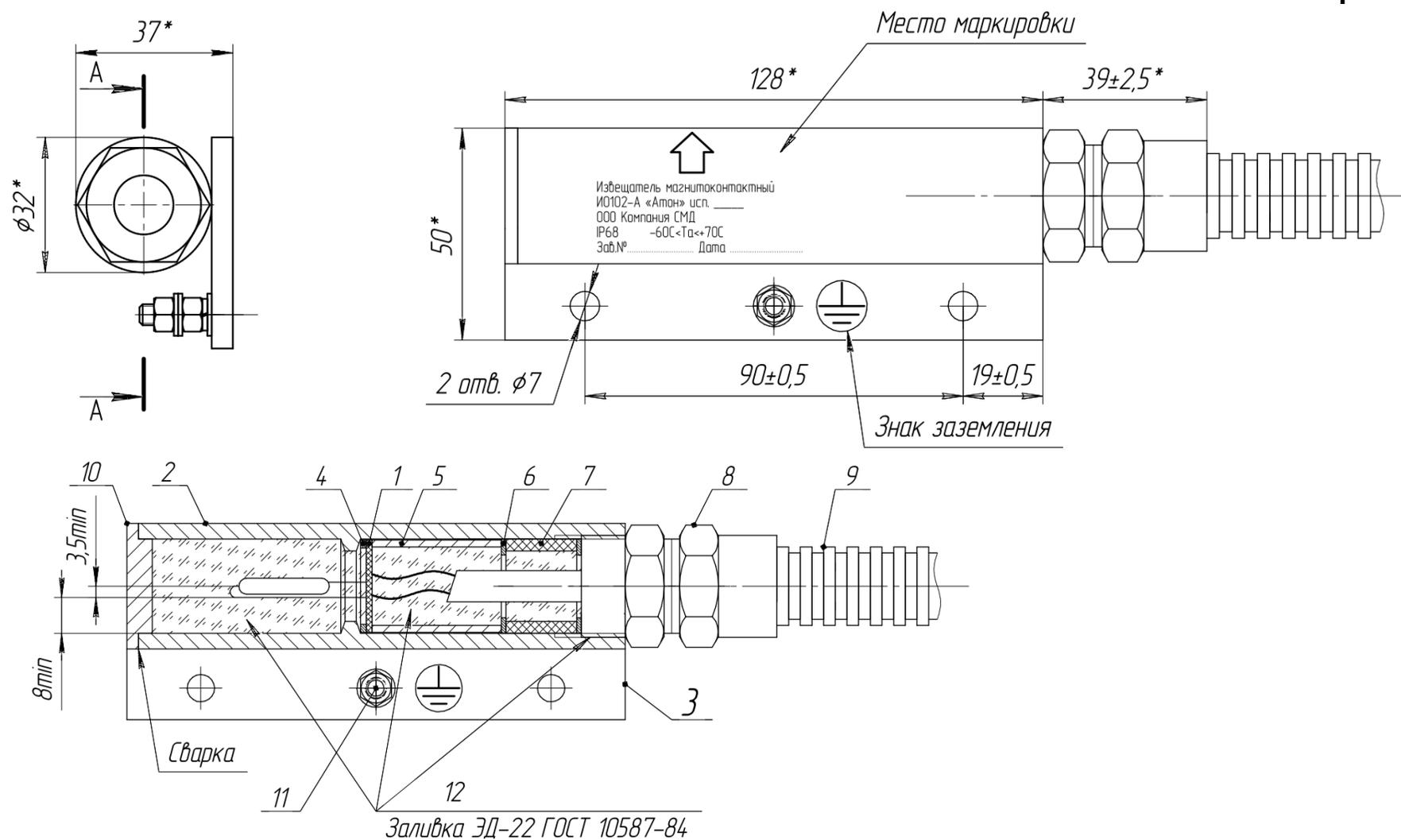
1 Плата с датчиком; 2 корпус; 3 основание; 4 контактное кольцо; 5 дистанционная втулка; 6 шайба; 7 уплотнительное кольцо; 8,9 кабельный ввод в сборе с металлорукавом; 11 внешний зажим заземления; 12 заливка компаундом.
