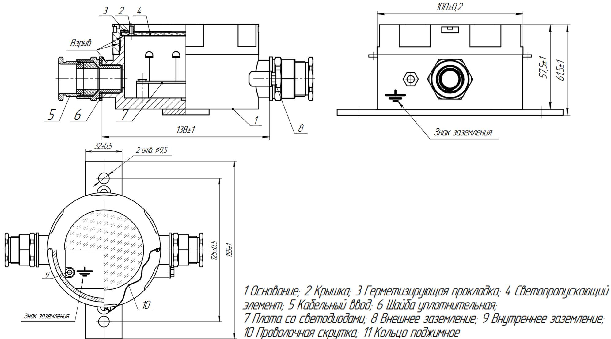
**Рис.А2 Конструкция оповещателя светового Орбита МК С Н (корпус из коррозионно-стойкой стали).**
