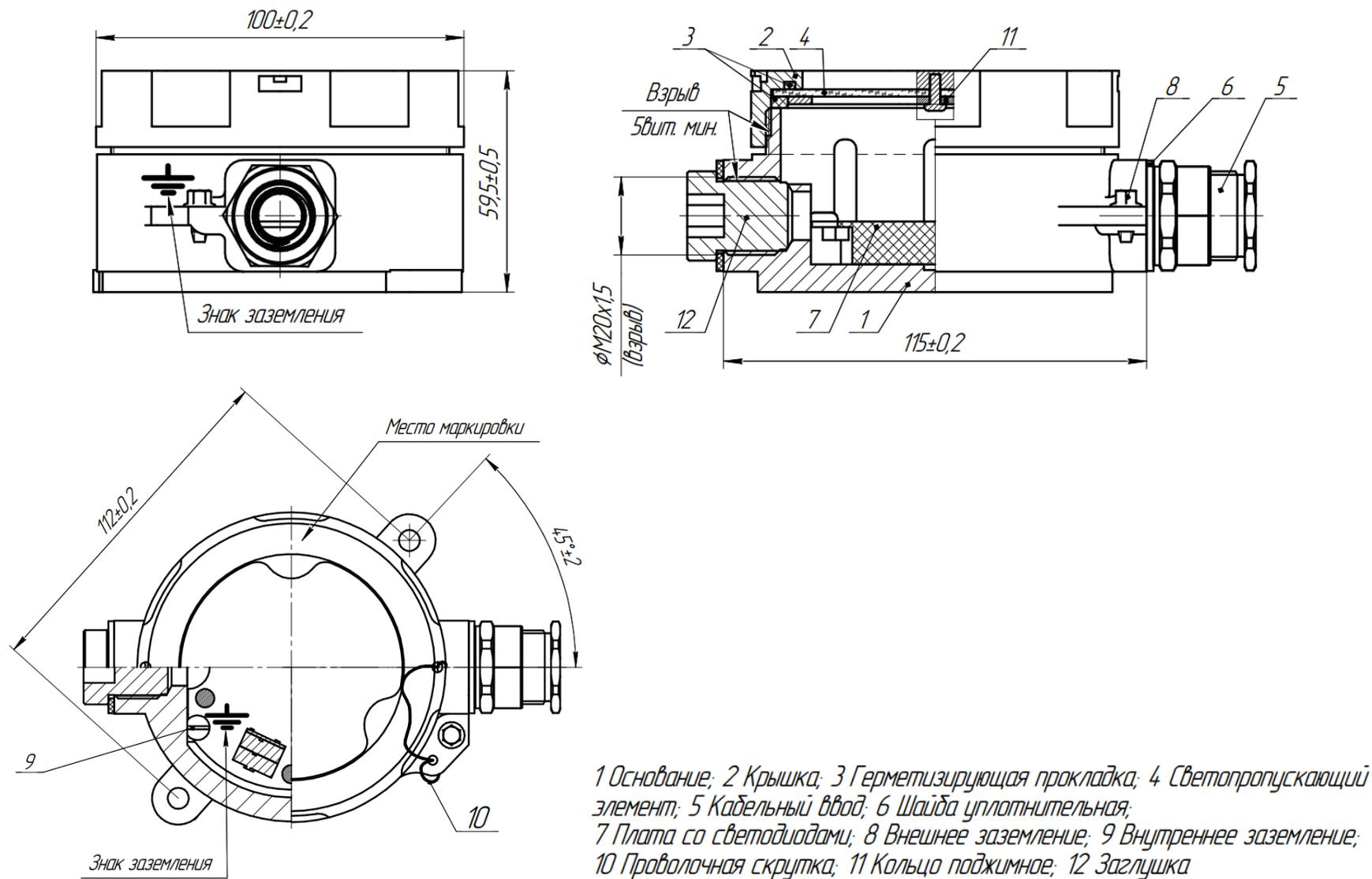
**Рис.А1 Конструкция оповещателя светового Орбита МК С А (корпус из алюминиевого сплава).**
