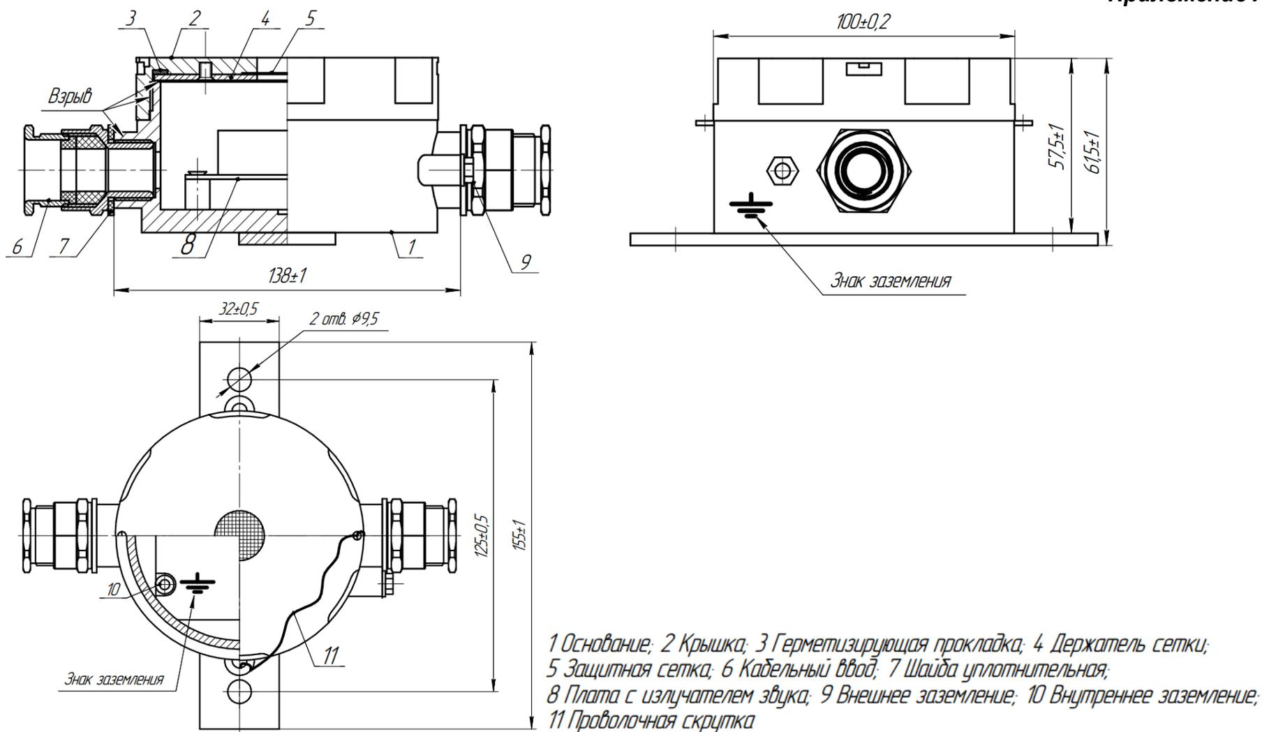
**Рис.А2 Конструкция звукового оповещателя Орбита МК 3 Н (корпус из коррозионно-стойкой стали).**
