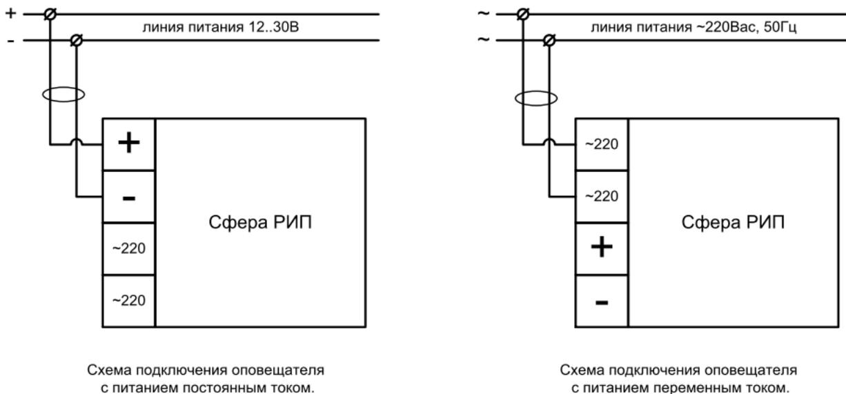
Табло подключать либо к источнику постоянного тока (12-30В), либо к источнику переменного тока ( $\sim 220\text{В} \pm 10\%$ ,  $50\text{Гц} \pm 2\text{Гц}$ ). Провода маркированы «+», «-» и «220», «220». Неиспользованные провода необходимо надежно изолировать.
