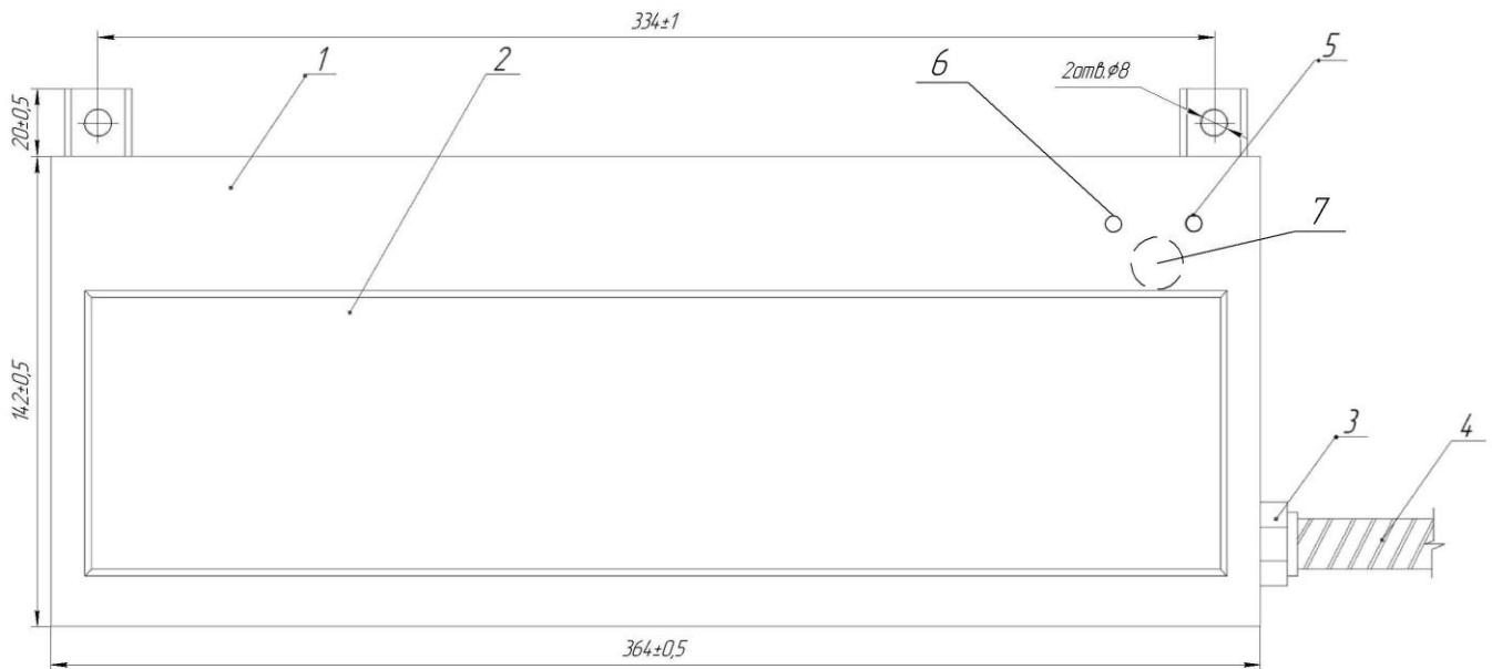
1 корпус; 2 светопропускающее окно; 3 кабельный ввод; 4 кабель питания; 5 индикатор «Сеть»;
