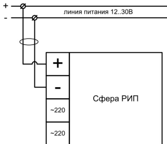
Схема подключения оповещателя
