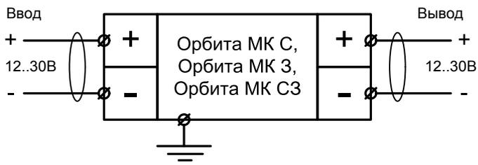
Схема подключения оповещателей
