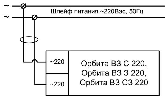
Схема подключения оповещателей
