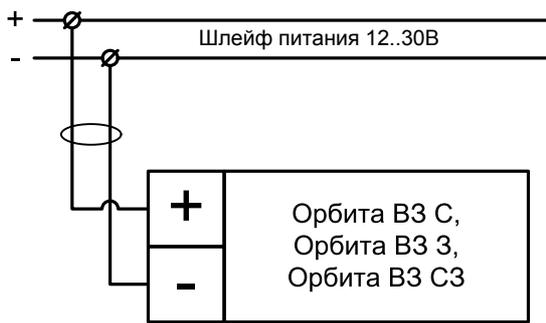
Схема подключения оповещателей
