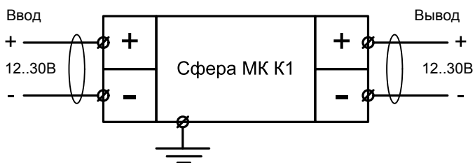
Схема подключения оповещателей Сфера МК Компл.1
