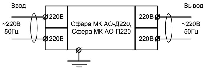
Схема подключения аварийных светильников
