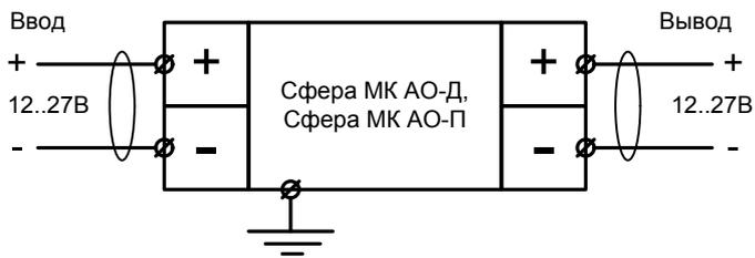
Схема подключения аварийных светильников
