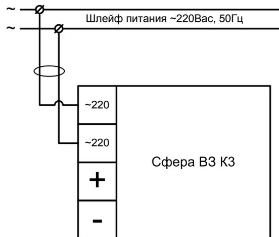
Схема подключения оповещателя
