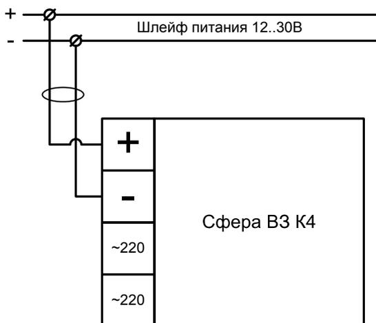
Схема подключения оповещателя
