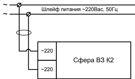
Схема подключения оповещателя
