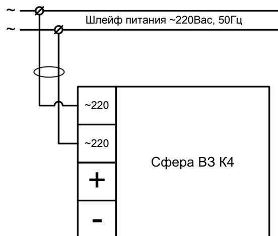
Схема подключения оповещателя
