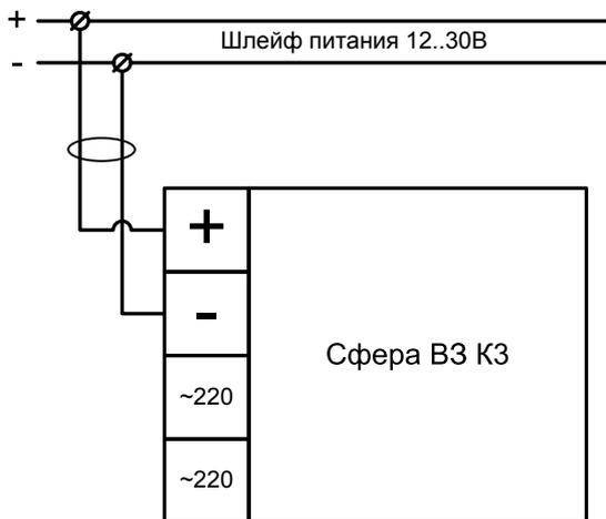
Схема подключения оповещателя
