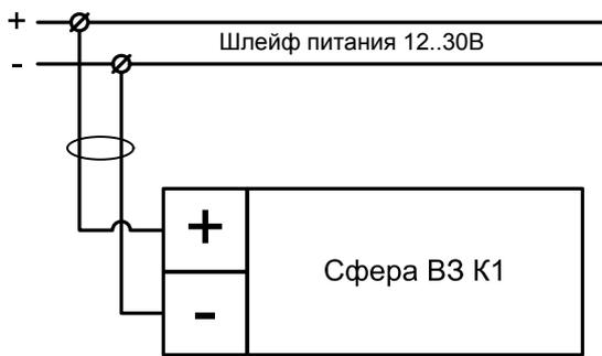
Схема подключения оповещателя
