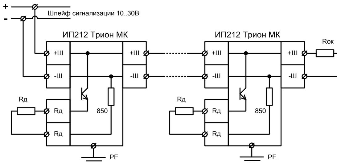
Схема подключения извещателя дымового ИП212 Трион МК.
