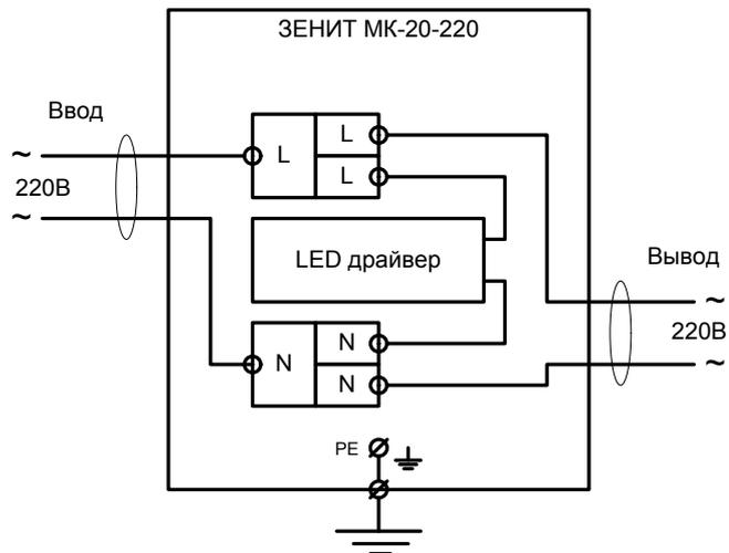
Схема подключения светильников Зенит МК-20-220 с питанием переменным током 176В-264В, 50-60Гц.
