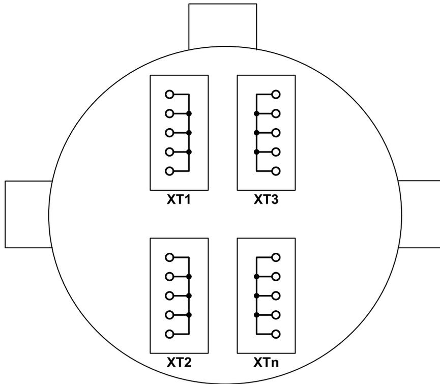
Монтажная коробка КВМК-тип А 1ExdIIBT5Gb. Схема соединений.
