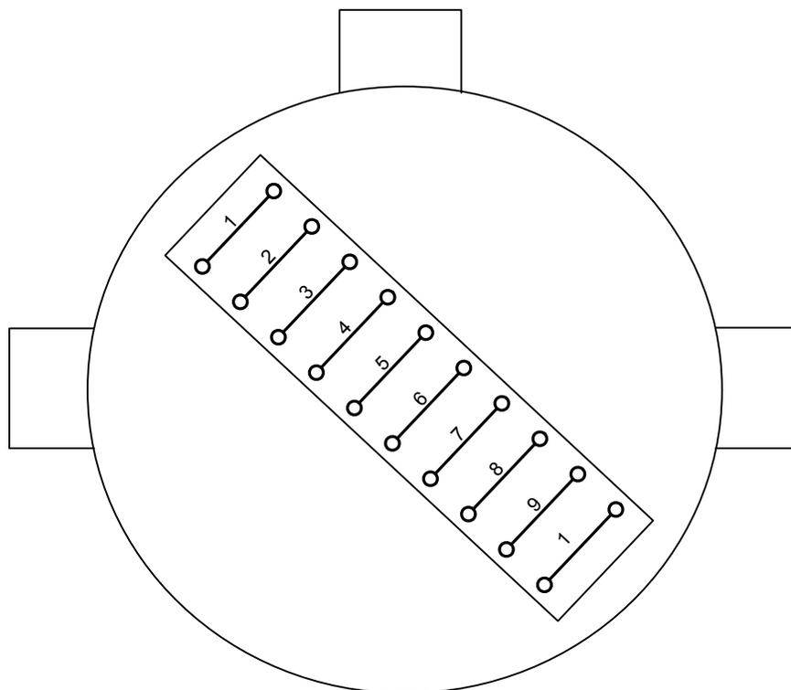
Монтажная коробка КВМК-тип А 1ExdIIBT5Gb. Схема соединений.
