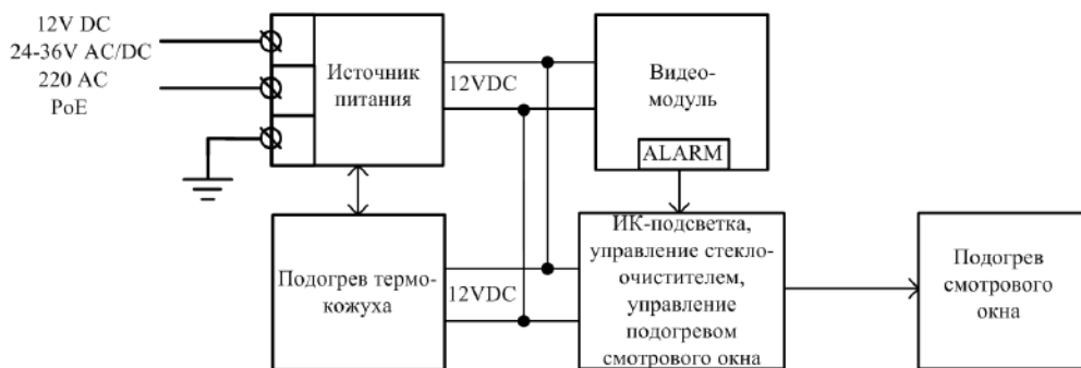
Структурная схема видеокамеры в варианте со стеклоочистителем
