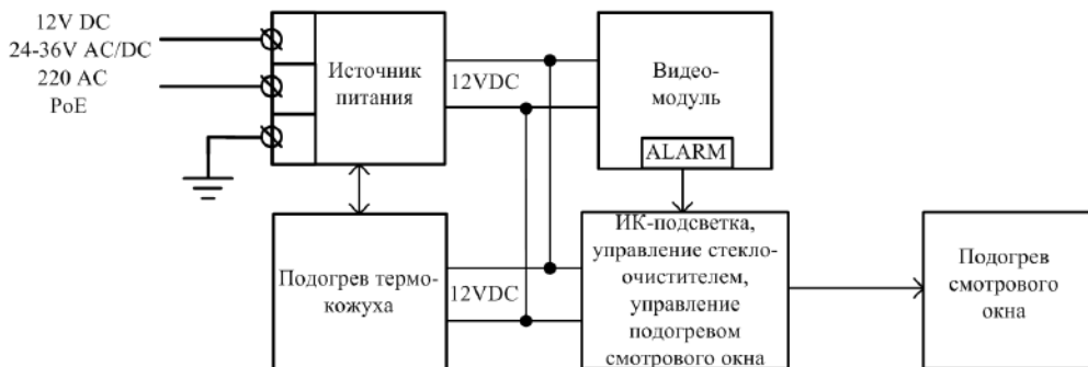
Структурная схема видеокамеры в варианте со стеклоочистителем
