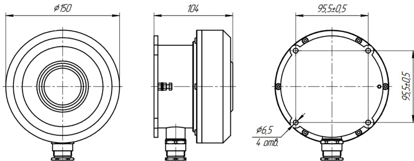
Рис.2 Габаритные и установочные размеры «Орион МК ВК FishEye»
