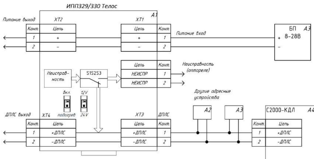
Питание извещателя осуществляется от отдельного блока питания. Напряжение питания 8-28В. Соблюдать полярность. Извещение «ПОЖАР» передается на ППКП по двухпроводной линии связи ДПЛС v2.xx «Орион». С помощью переключателей S1S2S3 (рис.2) выбирается способ выдачи сигнала «Неправильность».
