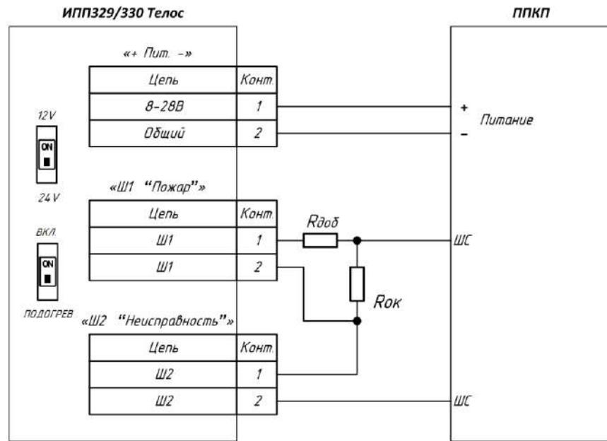
Извещение «ПОЖАР» передается на ППКП путем замыкания контактов реле «Ш1» («ПОЖАР»). Извещение «НЕИСПРАВНОСТЬ» передается на ППКП путем размыкания контактов реле «Ш2» («НЕИСПРАВНОСТЬ»). Оконечный (Рок.) и добавочный (Рдобр.) резисторы выбираются в соответствии с руководством на ППКП.
