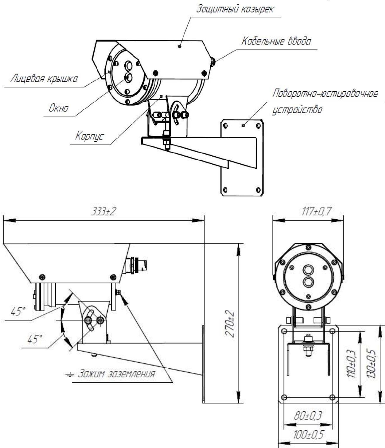
**Рис.А.1. Конструкция извещателя пламени серии ИП 329/ 330 Телос**
