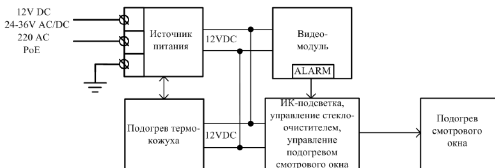
Структурная схема видеокамеры в варианте со стеклоочистителем
