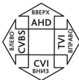
Рис.5 Управление OSD-джойстиком аналоговой камеры.
