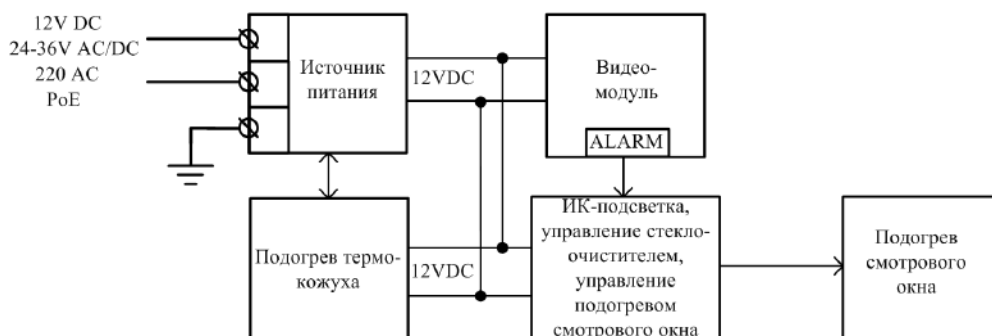
Рис.7 Структурная схема видеокамеры в варианте со стеклоочистителем
