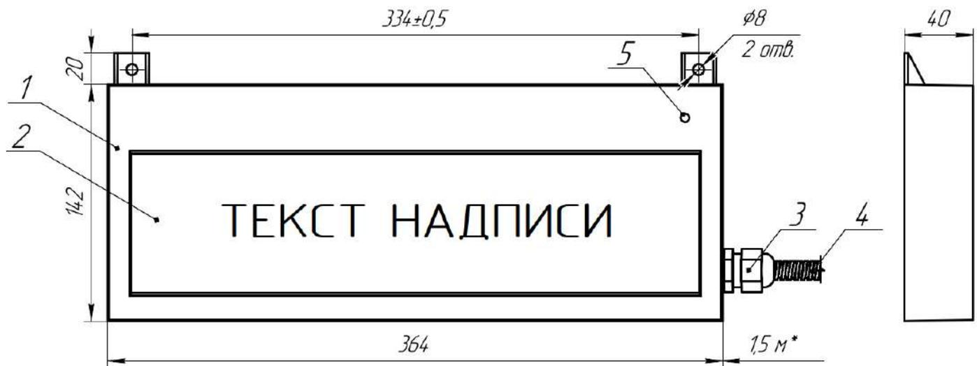
1 – корпус, 2 – табло с надписью (светопропускающая часть), 3 – кабельный ввод,
