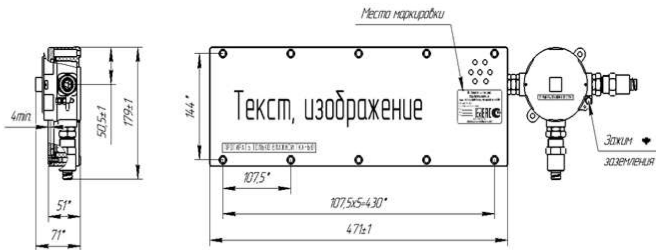
Рис. 4а. Габаритные и установочные размеры оповещателей светозвуковых СИРИУС ВЗ – Exmd - ПЛ – С312-24, СИРИУС ВЗ – Exmd - ПЛ - С3220.
