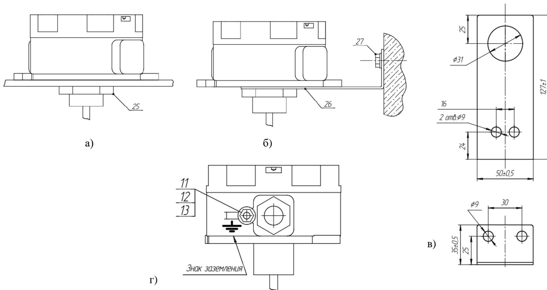
а) установка в резервуаре; б) установка на стене или потолке с помощью углового кронштейна;
