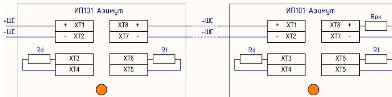
Rok – окончный резистор, выбирается в соответствии с требованиями ПКП, допускается установка Rok внутри корпуса последнего извещателя в шлейфе;
