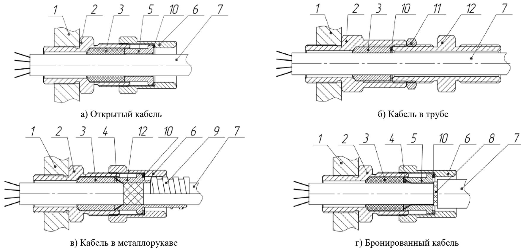
1 Оболочка; 2 корпус ввода; 3 уплотнительная втулка кабеля; 4 конус; 5 нажимная втулка;
