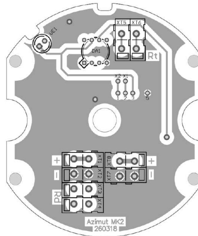
XT1, XT2, XT7, XT8 - клеммы подключения питания;
