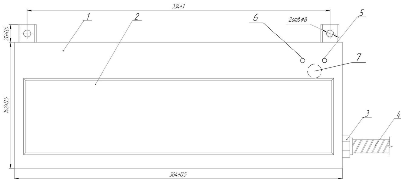
1-корпус; 2-светопропускающая часть; 3-кабельный ввод; 4-металлорукав; 5-индикатор «сеть»;
