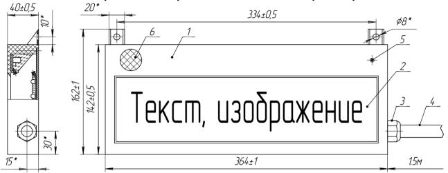
1 Корпус; 2 прозрачное окно; 3 кабельный ввод; 4 кабель питания; 5 индикатор (светодиод "Сеть"); 6 звуковой рупор.
