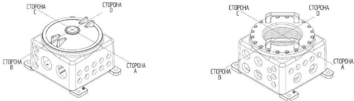
Рис. 2. Схема расположения отверстий под установку кабельных вводов в корпусе серии КВМК, СМД МК, моделей: КВМК 2.1 Exd-A-XXX... X, КВМК 2.1 Exd-H-XXX... X, КВМК 2.3 Exd-A-XXX... X, КВМК 2.3 Exd-H-XXX... X, СМД МК 2.1 Exd-A-XXX... X, СМД МК 2.1 Exd-H-XXX... X, СМД МК 2.3 Exd-A-XXX... X, СМД МК 2.3 Exd-H-XXX... X.
