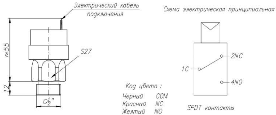
Рис. 5. Общий вид и схема подключения сигнализатора давления (СД) типа LF703.
