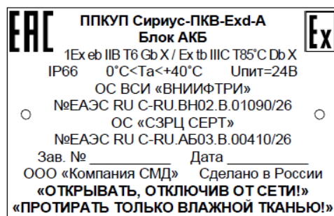
Рис.6 Пример маркировки блока АКБ «Сириус-ПКВ-Exd-A»
