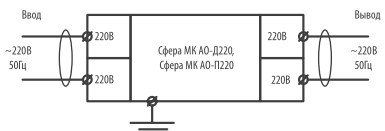
Схема подключения аварийных светильников Сфера МК АО-Д220, Сфера МК АО-П220
