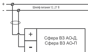
Схема подключения аварийных светильников Сфера В3 АО - Д, Сфера В3 АО - П
