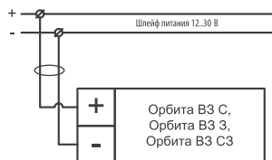
Схема подключения оповещателей Орбита ВЗ
