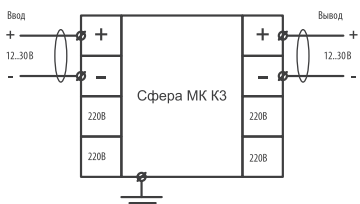
Схема подключения оповещателей Сфера МК Компл.3; питание постоянным током
