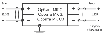
Схема подключения оповещателей Орбита МК С, Орбита МК 3, Орбита МК С3
